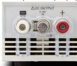
Защитная крышка входит в комплект для моделей с выходным напряжением выше 70 В.
